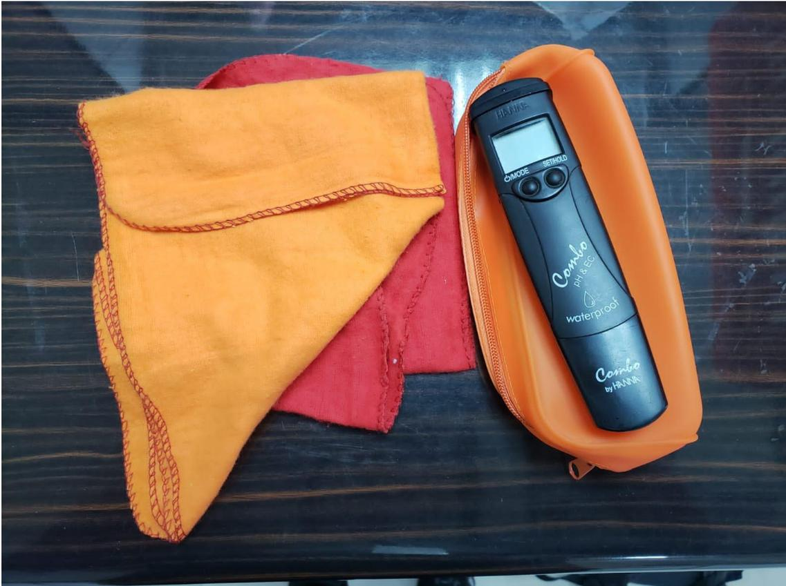
Figura 4. Herramienta principal para medir la conductividad eléctrica y pH de las soluciones nutritivas: Medidor de EC y pH marca Hanna.
