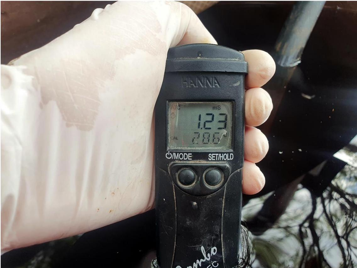
Figura 9. Medidor marca Hanna, midiendo la conductividad eléctrica a 1.23 mS
