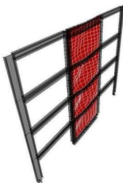
Figura # 14. Deformaciones en los muros, modelo de 4 pisos.
