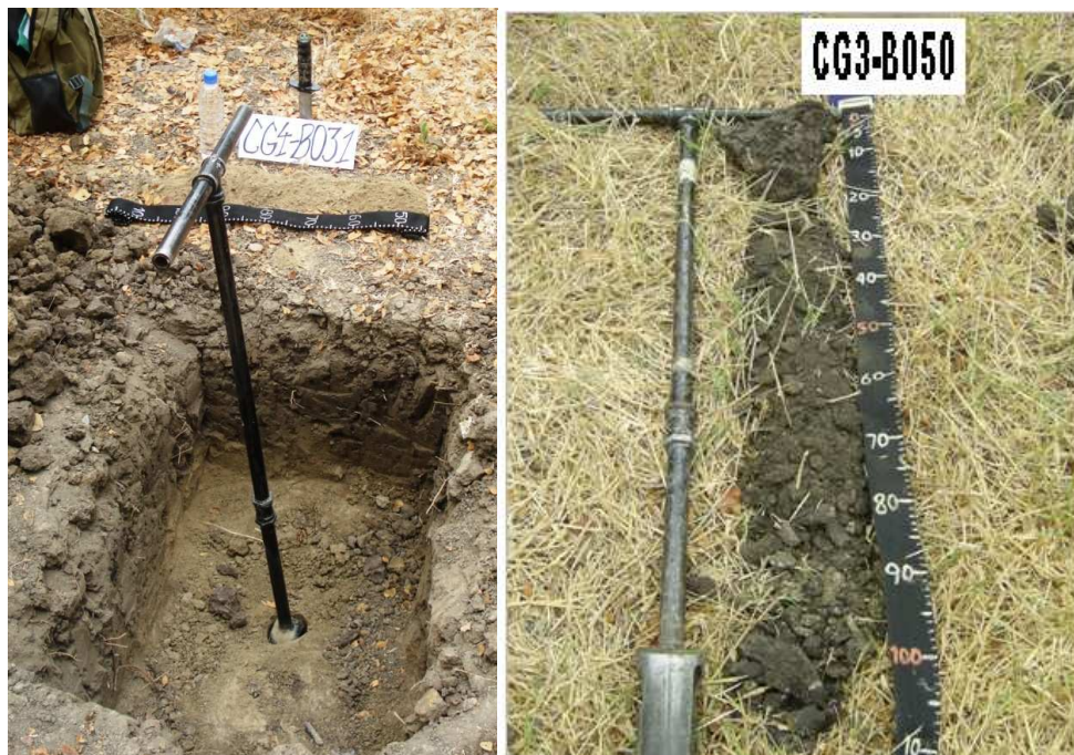
Figura 10. Barrenaciones realizadas con el barreno tipo EDELMAN.
