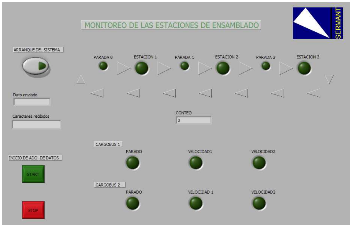
Figura 5.7 Panel de control programado para el arranque y monitoreo del sistema.
