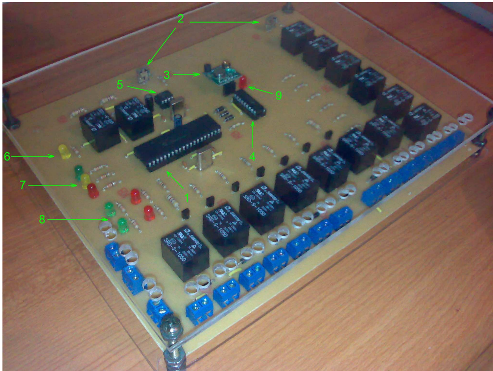
Figura 4.3 Módulo de comunicación de cargobuses. 1. Microcontrolador principal PIC16F877A. 2. Receptores infrarrojos IRM860S. 3. Transmisor de radiofrecuencia FST-3. 4. Encoder de RF HT12E. 5. Microcontrolador PIC12F675. 6. Indicador de encendido. 7. Indicadores de velocidad del cargobus. 8. Indicadores de asenso o descenso de carga. 9. Indicador de estado de la transmisión RF.
