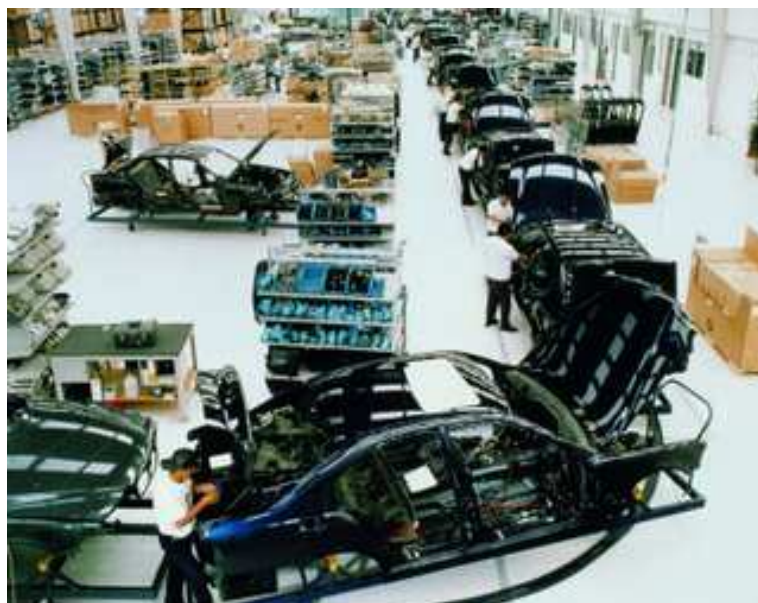
Figura 1.2 Sistema de transporte por rieles para ensamblaje ( BMW Group México )
