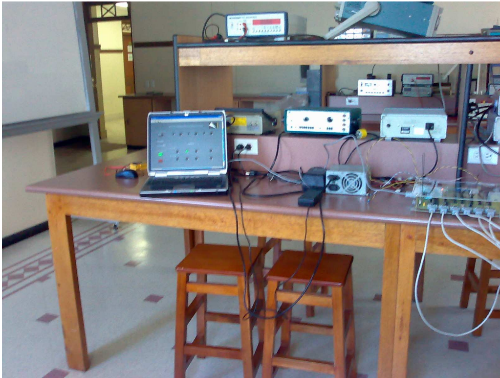
Figura 5.1 Computador personal conectado serialmente al módulo de comunicación central a través de un cable UTP 5e.
