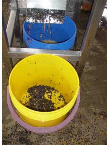
Foto 5. Acumulación de desperdicio en despulpadora
