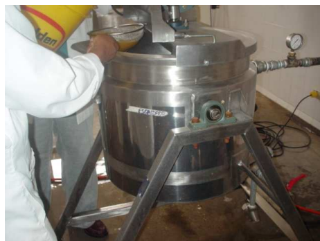
Foto 10. Marmita para el escaldado térmico
