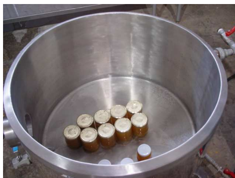
Foto 11. Tanque de enfriamiento
