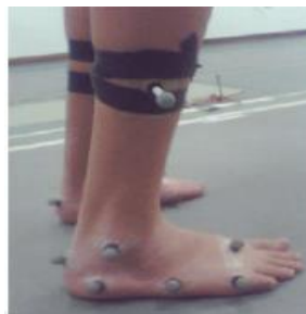
Figura 20 Posicionamiento referencial para prueba estática del sistema IMU
