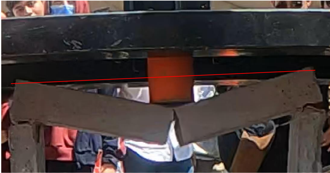
Figura 7. Falla de pórtico por carga de impacto a un metro de altura por flexión pura.
