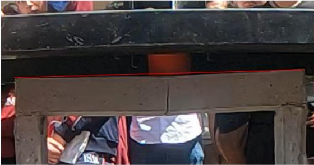
Figura 2. Deformación máxima obtenida en el pórtico a una altura de 0.50 cm. Fuente: Competencia de pórticos de impacto, casa abierta USFQ (2023).
