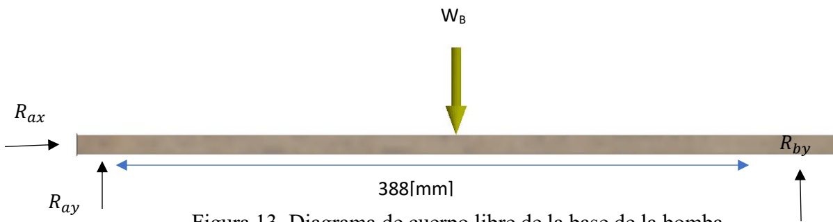
Figura 13. Diagrama de cuerpo libre de la base de la bomba
