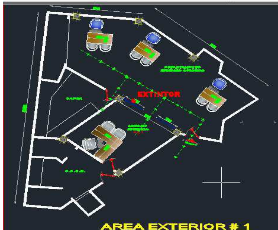
Figura 7. Plano descriptivo de Legal y Planificación, de las Instalaciones de Refinería del Pacífico, donde se identifica la Salidas de Evacuación e identificación de extintores.
