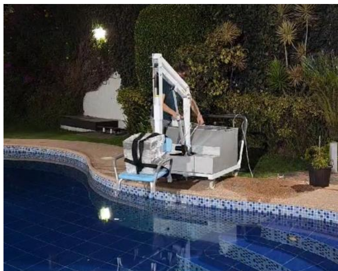
Figura 50: Pruebas realizadas de la grúa con 48 kg.
