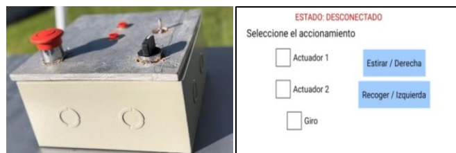
Figura 11. Paneles de control
