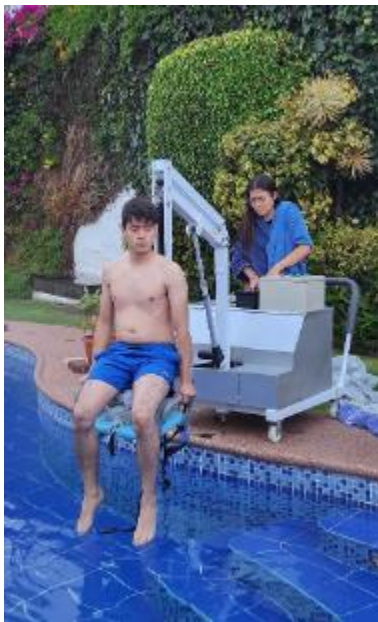
Figura 51: Pruebas realizadas de la grúa con 100 kg.
