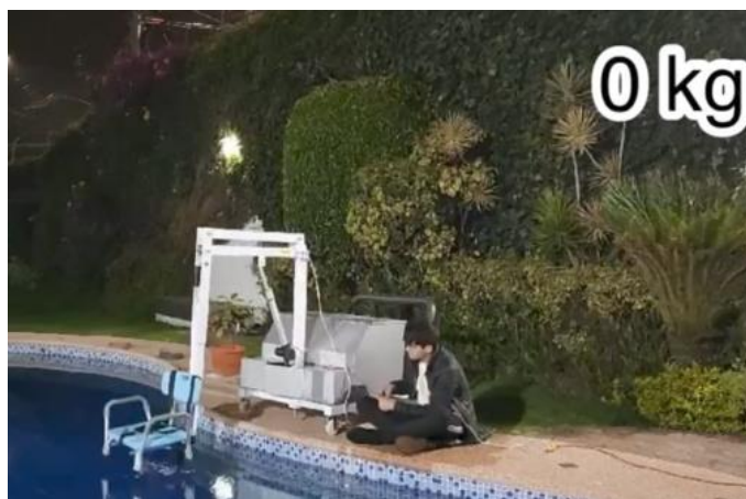
Figura 49: Pruebas realizadas de la grúa con 0 kg.
