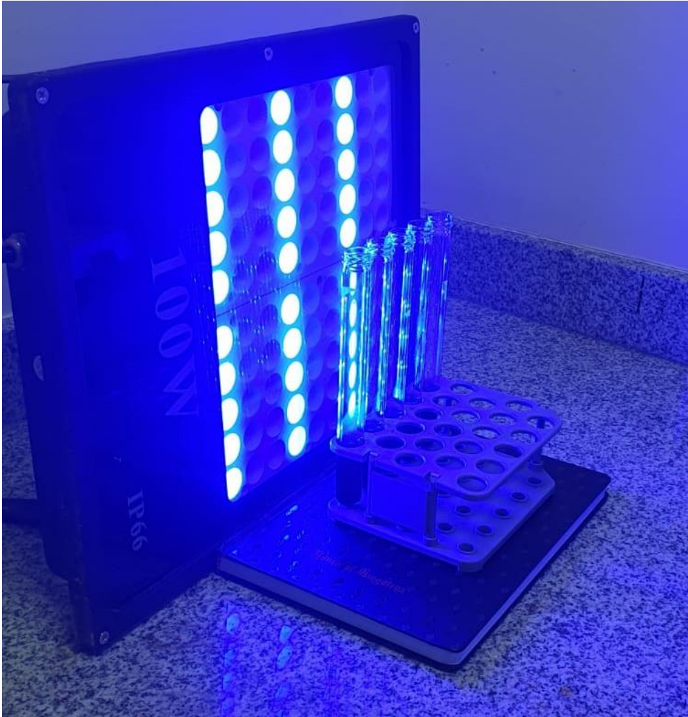
Figura 1 C. Proceso de iluminación con luz azul LED a tubos de ensayo con solución de extracto para la formación de las AgNPs.
