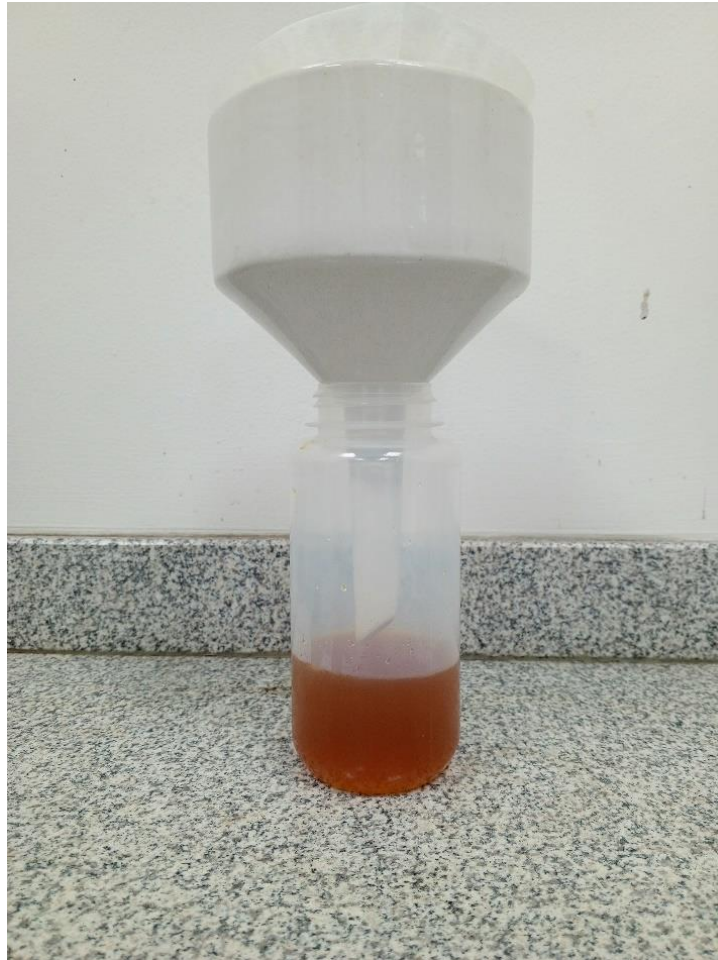
Figura 1 A. Proceso de filtración del licor de cáscara de cacao, para separar la fase sólida (hydrochar) y líquida (licor).
