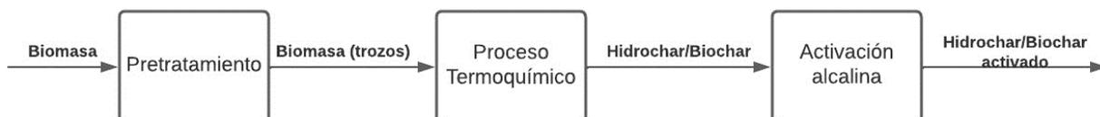
Figura 3: Diagrama de bloque del proceso de producción de hidrochars y biochars activados.
