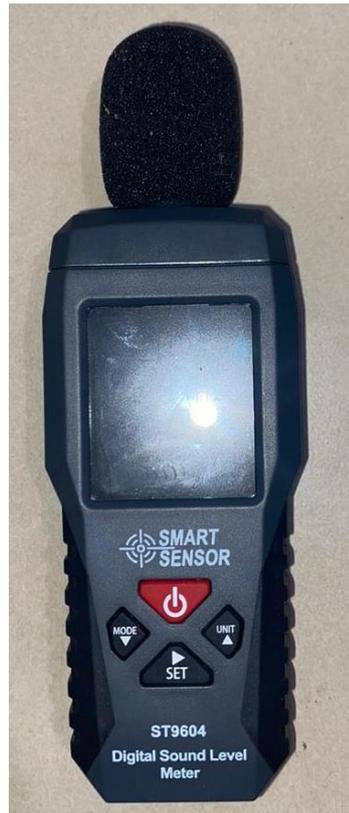
*Figura 4. Sonómetro utilizado para mediciones*
