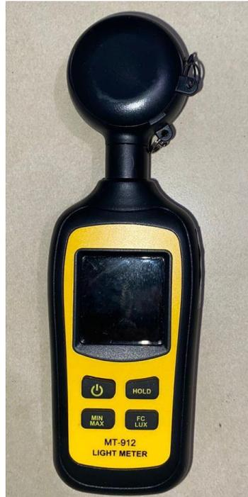
*Figura 3. Luxómetro utilizado para mediciones*
