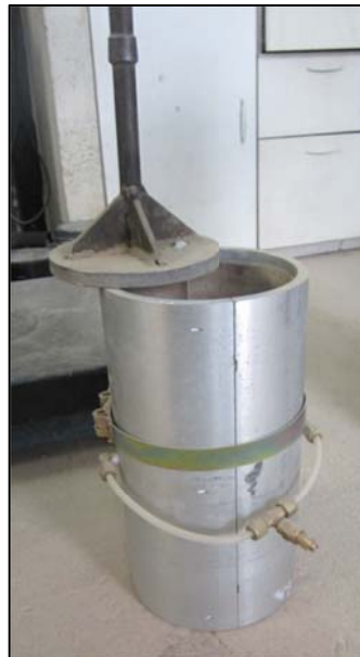
Figura 2.10 Molde partido de acero y pie de acero para compactación de muestras
