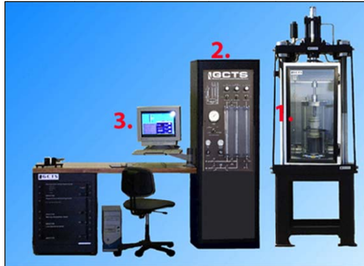
Figura 2.1 Equipo moderno de Módulo Resiliente y sus partes
