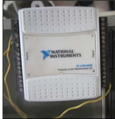
Figura 2.8 DAQ, sistema de adquisición de datos
