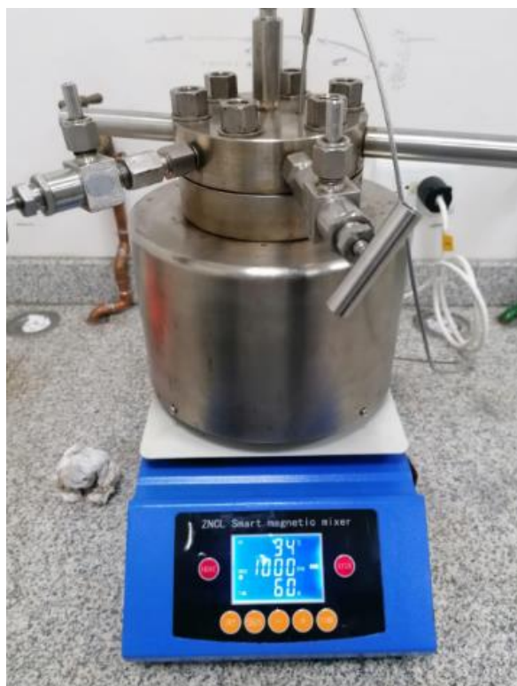
Figura 35. Reactor de alta presión a escala de laboratorio TGYF-B del laboratorio de la Universidad San Francisco de Quito (USFQ).
