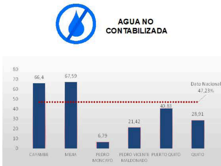
Ilustración 15 - Agua no contabilizada cantón Quito
