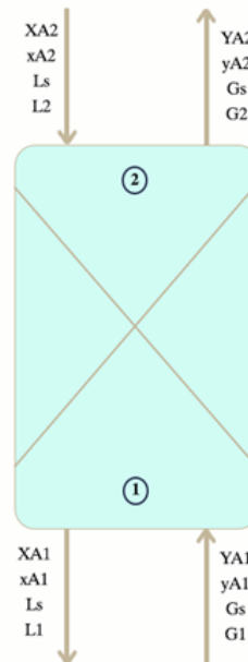
Figura 11. Diagrama de flujos de la columna de lavado
