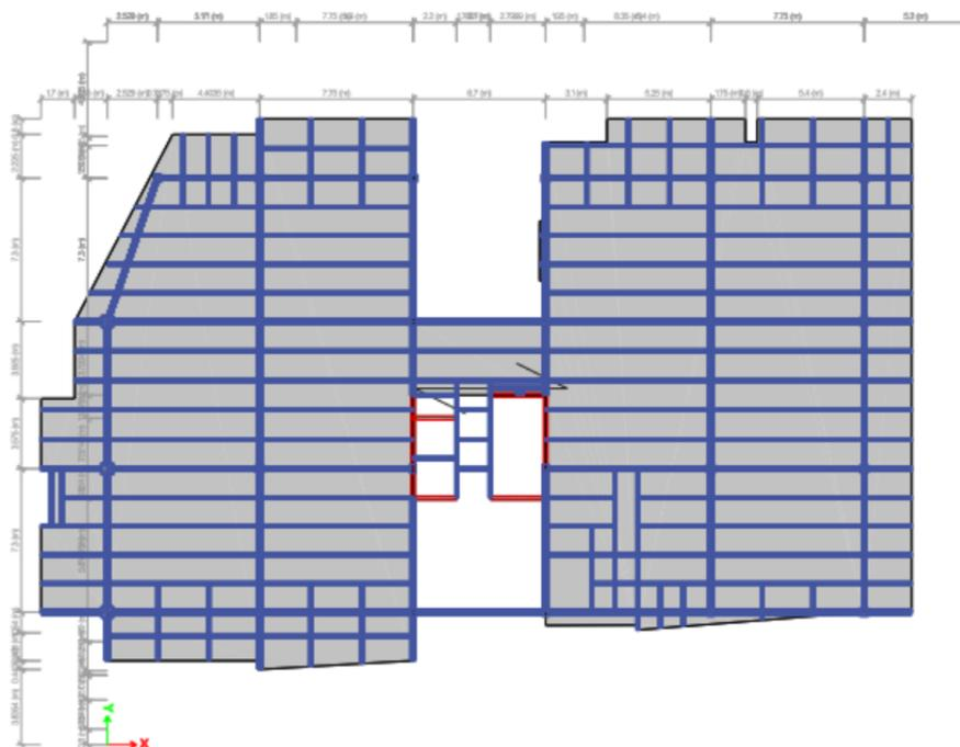
Figura 26: Vista en planta del nivel típico del Edificio A en ETABS.
