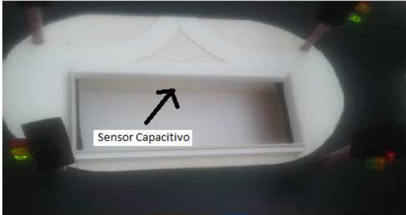
Ubicación del sensor de Nivel de agua en la maqueta
