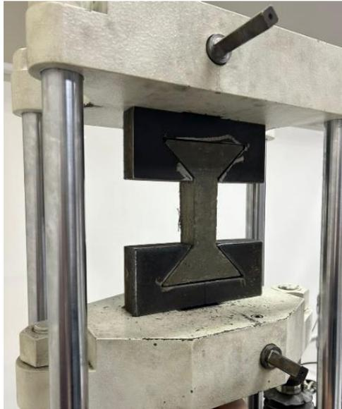
Figura 9. Probeta instalada en máquina de tracción
