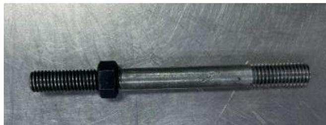
Figura 5. Espárrago para conexión entre mordaza y máquina de tracción
