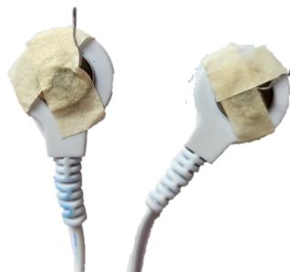
Figura 2. Modificación de los electrodos para electroestimulación precisa.
