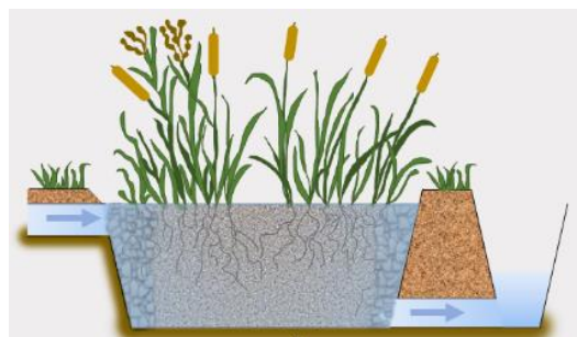
Figura 10. Humedal de flujo sub-superficial horizontal. Fuente: (Montenegro-Rosero et al., 2019)
