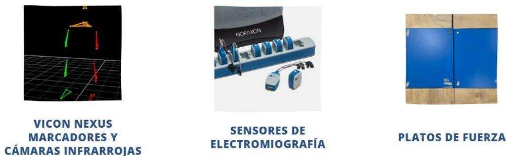
Figura 2. Instrumentación utilizada
