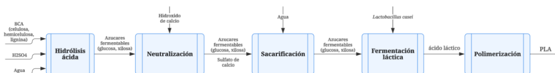
Figura 1. Diagrama de flujo de la biorrefinería del ácido poliláctico
