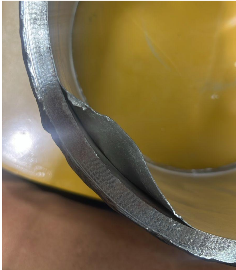
Figura #90. Capa de Babbitt levantada en tubo de 6 in
