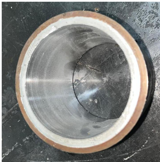
Figura #92. Tubo recubierto de 4 in. maquinado en el torno
