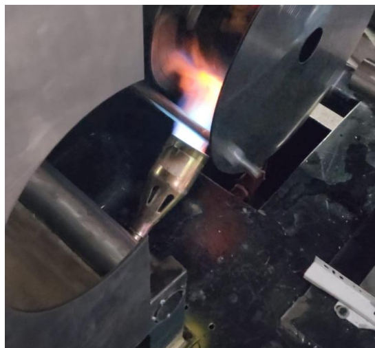
Figura #30. Antorcha prendida precalentando el tubo
