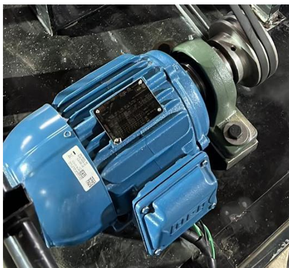
Manual de operación figura #2. Motor trifásico con sistema de poleas doble en V
