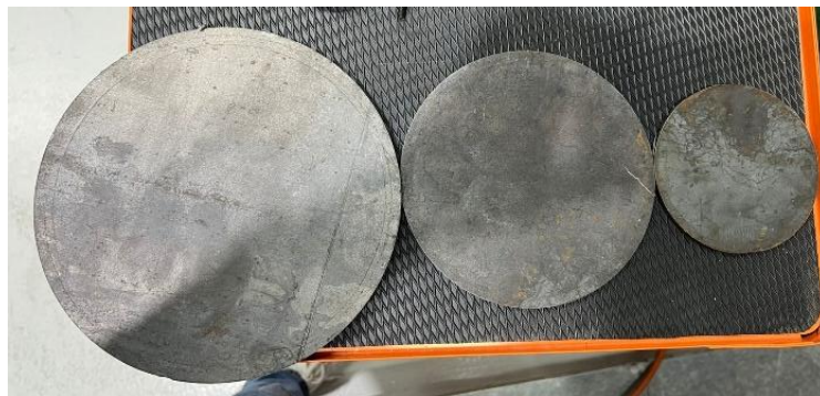
Manual de operación figura #10. Tapas protectoras traseras de Cojinetes
