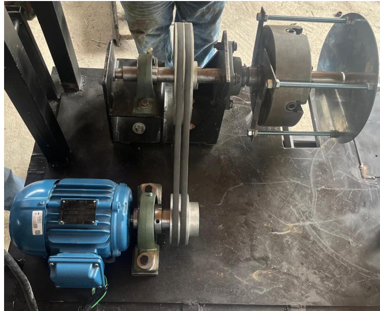
Figura #29. Cojinete sujetado con el mandril
