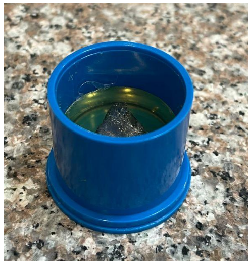
Figura #83. Montaje de la muestra de Babbitt
