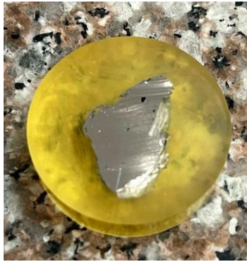
Figura #84. Muestra montada de Babbitt en resina
