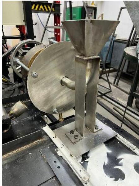
Manual de operación figura #17. Deslizamiento de colador hacia cojinete
