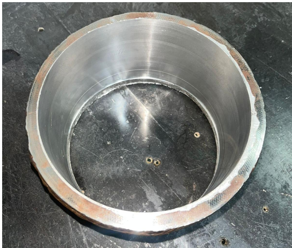
Figura #89. Tubo recubierto de 6 in. maquinado en el torno
