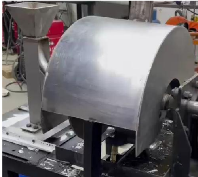
Figura #32. Cubierta de seguridad y Colador
