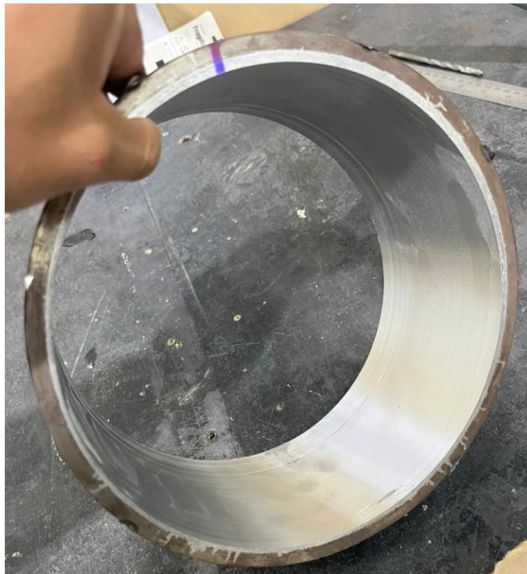
Figura #91. Tubo recubierto de 8 in. maquinado en el torno
