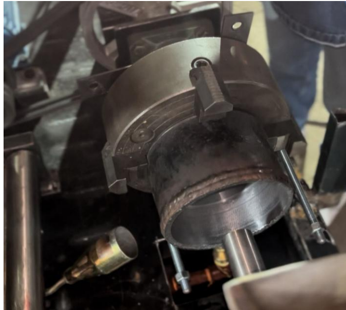
Figura #28. Cojinete sujetado con el mandril
