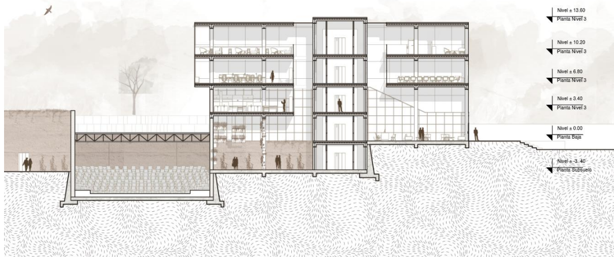
Figura 42 Corte Longitudinal "D"
