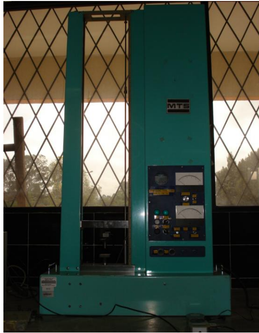
Fig. 15 Máquina para pruebas de tensión y presión ( JJ machine type T5002)
