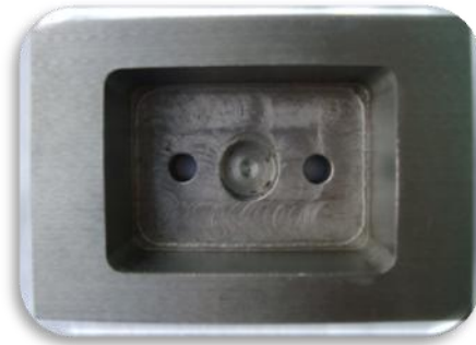
Fig. 3. Dispositivo diseñado para la elaboración de los moldes de acrílico y para la colocación de la corona bovina.
