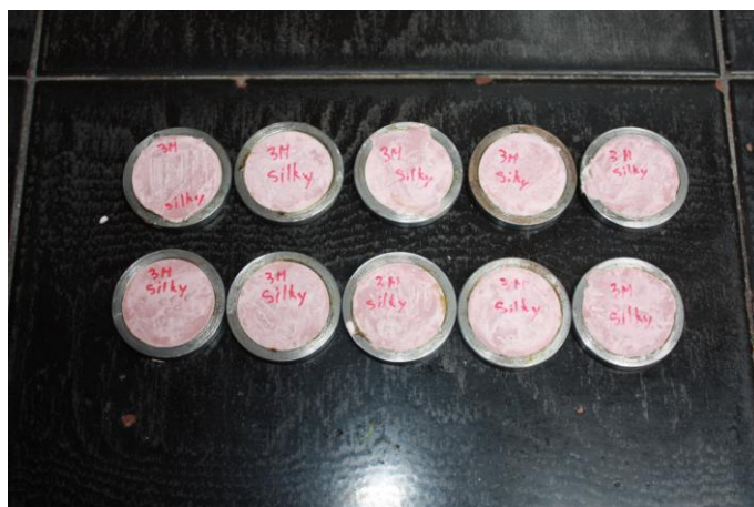
Gráfico 34. Vaciado y vibración de las muestras
