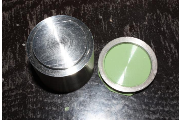
Gráfico 30. Impresión lista para vaciarse
