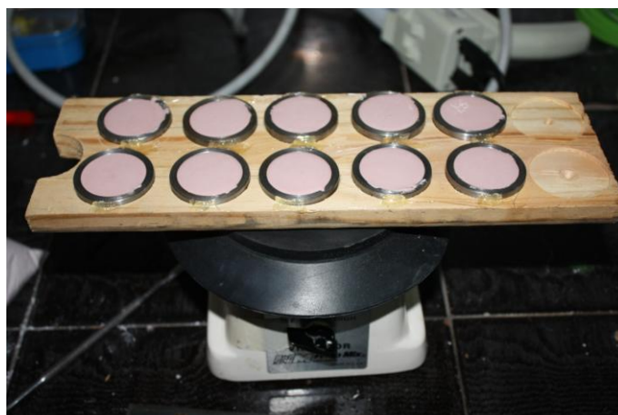
Gráfico 34. Vaciado y vibración de las muestras
