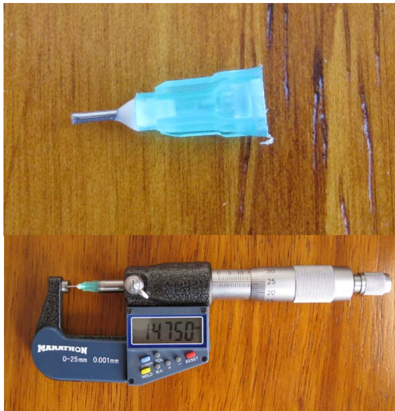
Figura 15. Punta de jeringa adaptada para el Micrómetro Digital.
