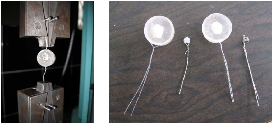
Figura 26. Muestras durante la prueba de cizallamiento y luego de descementados los brackets.
