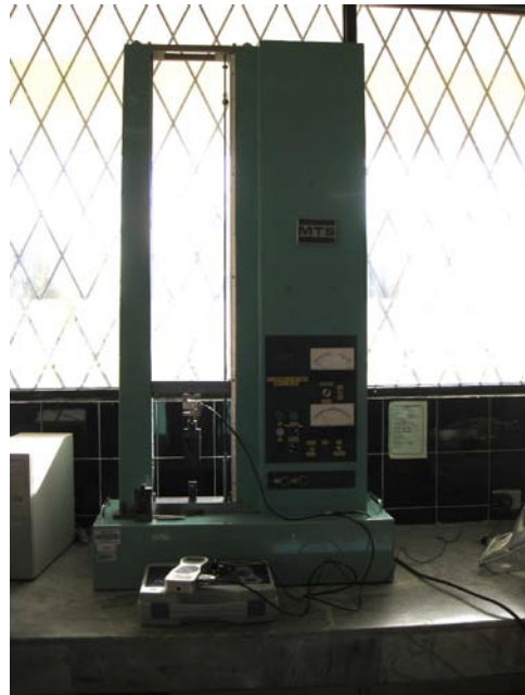
Figura 25. Máquina de ensayos universales (MTS, modelo T-5002).
