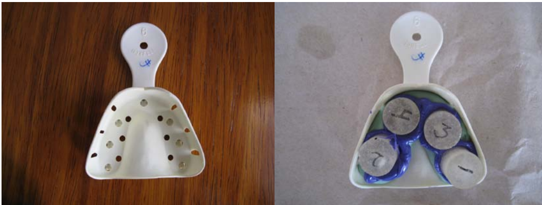
Figura 27. Toma de impresión de las muestras que se evaluaron al microscopio electrónico de barrido.
