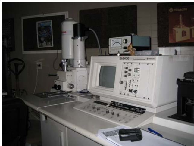
Figura 28. Microscopio electrónico de barrido (Hitachi modelo S-2400).
