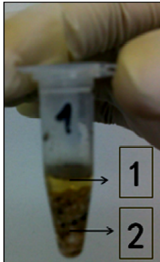
Figura 4: Tubo Eppendorf con muestra de orina en arena. Se observa claramente dos fases. 1) alcohol y orina. 2) granos de arena precipitados
