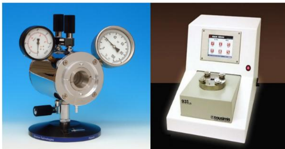
Figura 2. Secadores de Punto Crítico manual vs automático.
