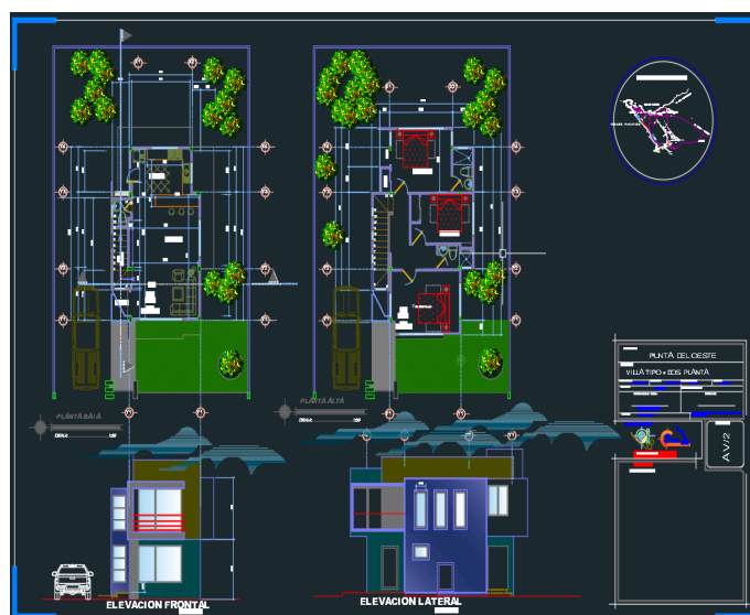
Figura # 48: Plano de Casa tipo B de dos plantas de 97 m 2
