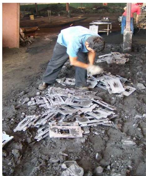
Ilustración 5. Desmoldeo de piezas
