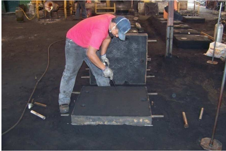
Ilustración 2. Preparación de Moldes
