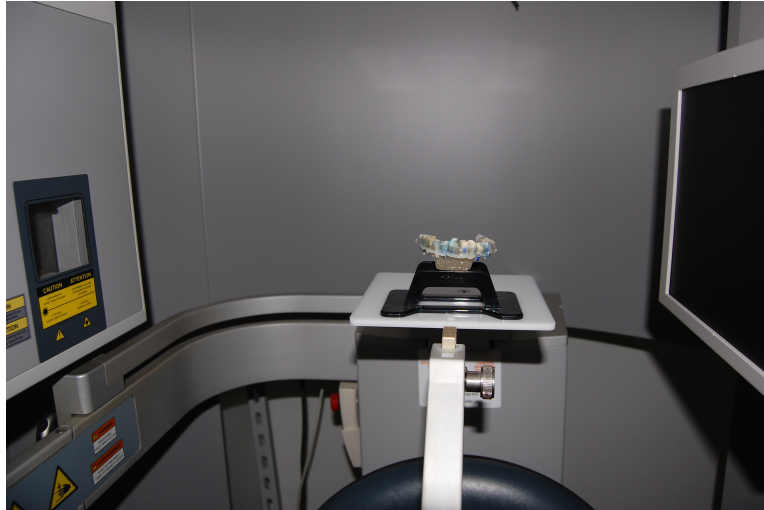
Fig. 9 Troquel fijado en el tomógrafo
