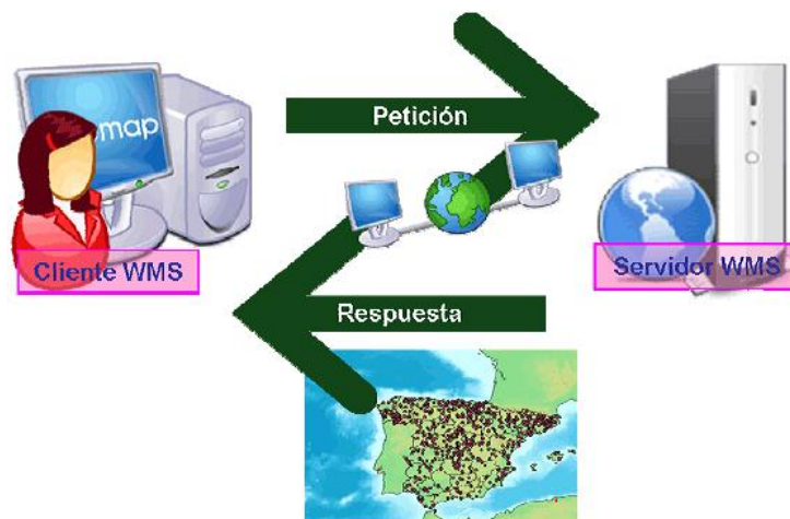
Figura No. 5. Arquitectura Cliente-Servidor Fuente: IGN, 2010
