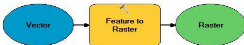
Gráfico N°23.- Estructura para la conversión de formatos vector a raster con Model Builder
