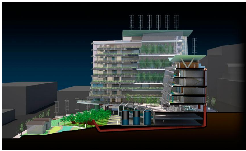
Ilustración44: Funcionamiento de energías pasivas y activas( http://www.weberthompson.com/eco-laboratory.html )
