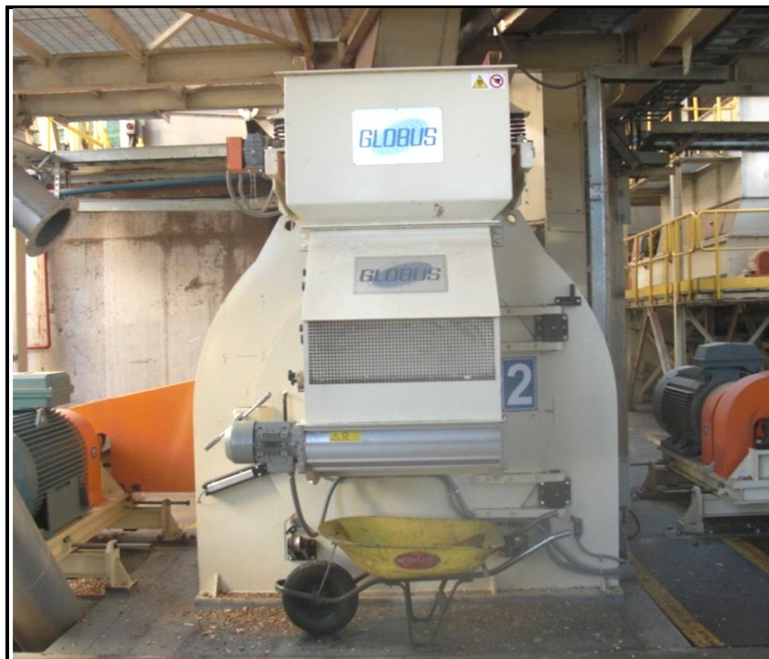
Ilustración 4. Molino procesador de chips “Globus”
