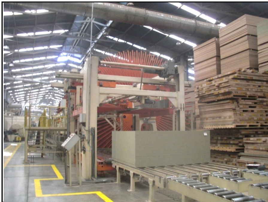
Ilustración 10. Paquete de tableros formados a la salida del enfriador.
