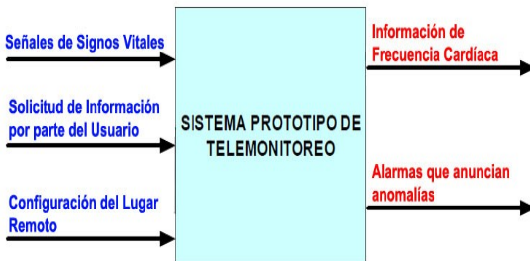
Figura 12: Diagrama de Entradas y Salidas del Sistema (Elaboración Propia)
