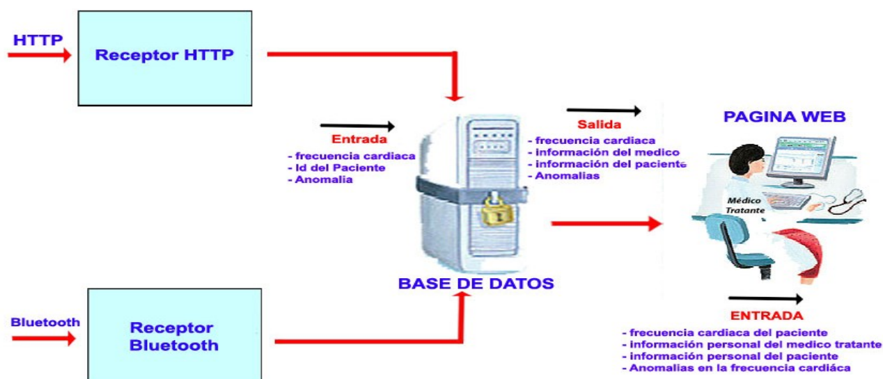
Figura 18: Diagrama de Bloques del Servidor Central (Elaboración Propia)
