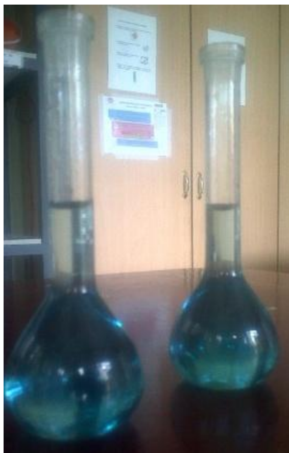
Figura 4 Fotografía de la medición de sulfuro por el método colorimétrico de azul de metileno (Fotografía por Daniela Flor)
