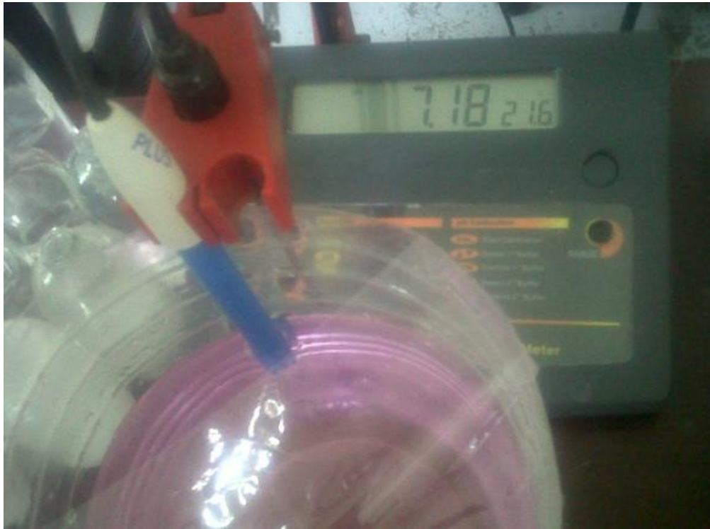
Figura 3. Fotografía del medio basal alimentado al reactor biológico compuesto de 2500 mg DQO-acetato L^{-1} como donador de electrones y sulfato en concentraciones de 4000, 3000 y 2000 mg L^{-1} como aceptor de electrones con un pH entre 7.1-7.3 (Fotografía por Daniela Flor).
