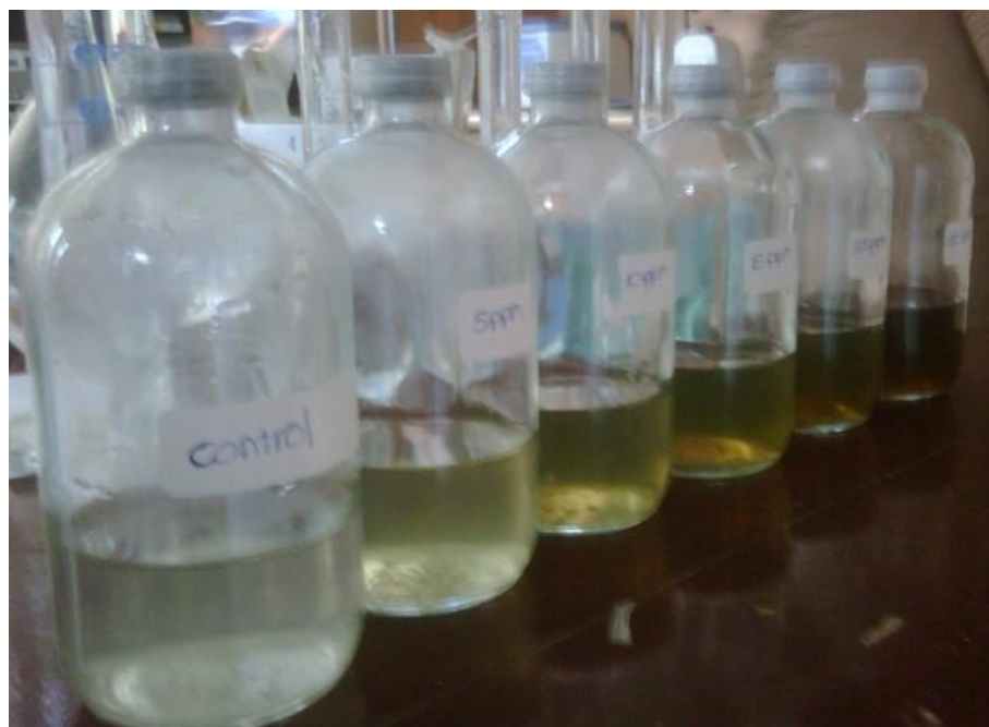
Figura 8 . Fotografía de los experimentos Batch para evaluar la precipitación de \text{CuS} Los ensayos corresponden a un control (ausencia de cobre (II)) y diferentes tratamientos con concentraciones en aumento de cobre (II) de 5, 10,15, 25 y 50 \text{mg L}^{-1} correspondientes a los tratamientos T-1, T-2, T-3, T-4 y T-5, respectivamente (Fotografía Daniela Flor)
