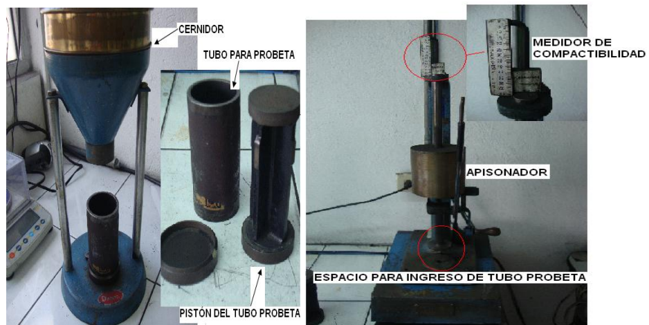
Figura. N.19. Equipo para generación de muestras o probetas de arena verde de moldeo. Fotografía propia permitida por JCR Fundiciones
