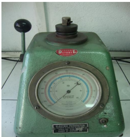
Figura N.21. Equipo Permeámetro Eléctrico #338B. Fotografía propia permitida por JCR Fundiciones
