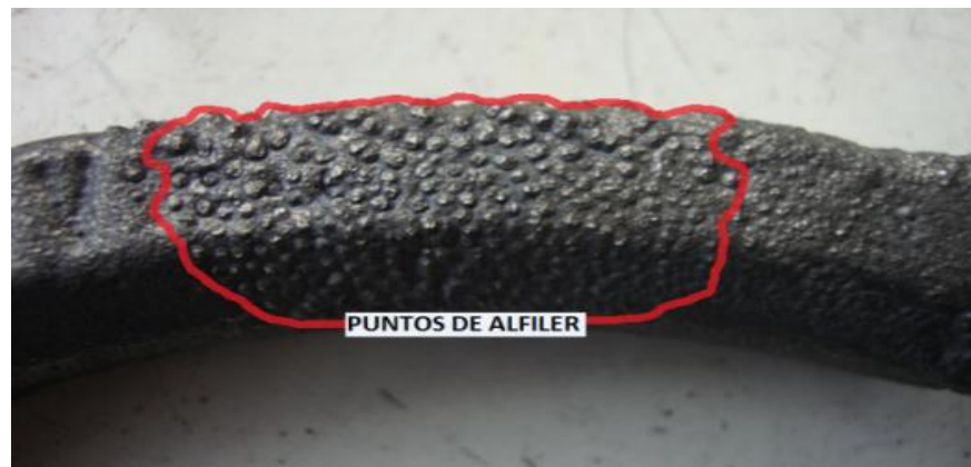
Figura N.9 Defecto: Puntos de alfiler. Fotografía y modificación propia.
