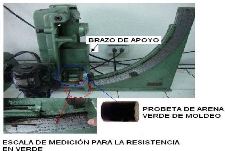
Figura N.18 Máquina universal de fuerza de Arena N# 400. Fotografía propia, permitida por JCR Fundiciones
