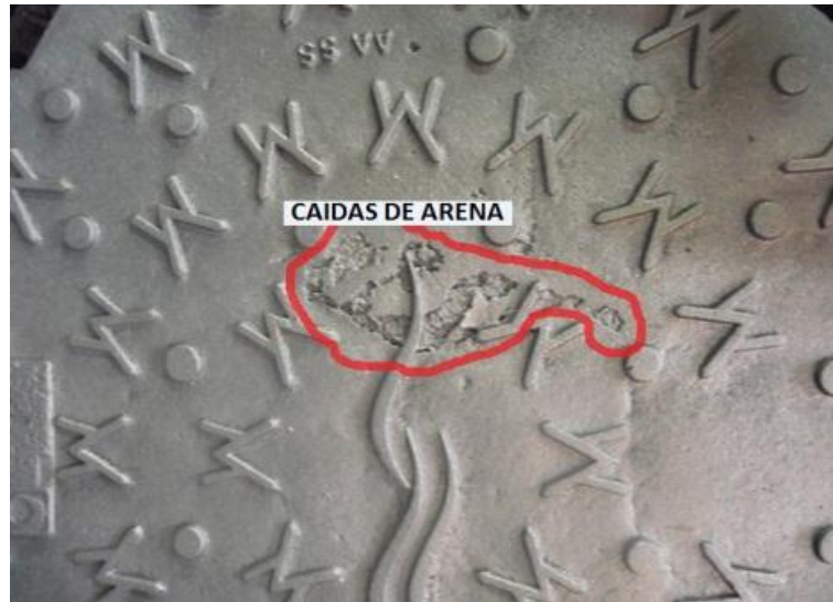
Figura N.10 Defecto: Caídas de arena. Fotografía propiedad de JCR Fundiciones. Modificación propia.
