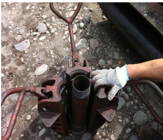
Imagen No. 5 Manos en riesgo en cuñas Fuente: Autor
