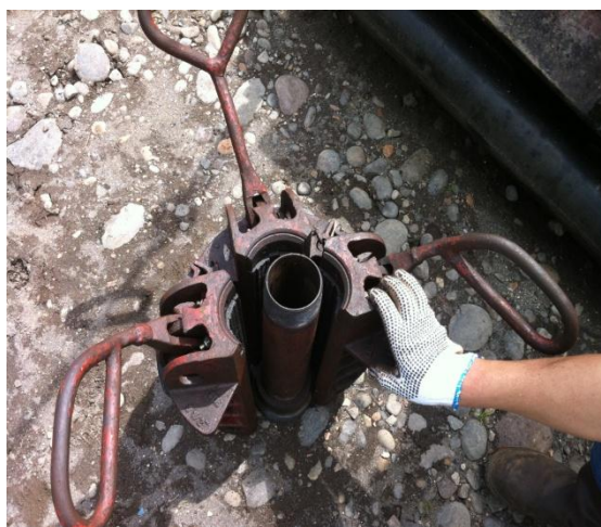
Imagen No.6 Manos en riesgo en cuñas Fuente: Autor
