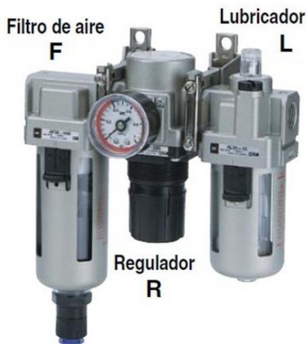
Figura 5-3: Conjunto Filtro, Regulador, Lubricador
