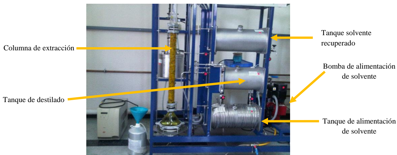
Figura 13 Foto del equipo de extracción líquido-líquido UOP5 ARMFIELD armado para la extracción
