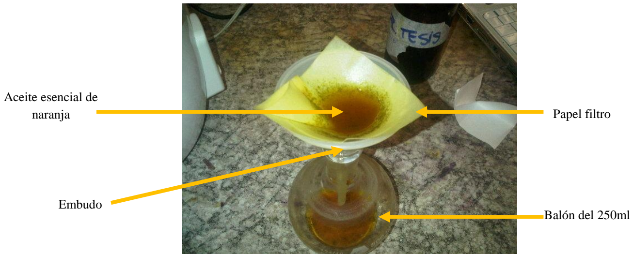
Figura 16 Proceso de filtración del aceite esencial de naranja
