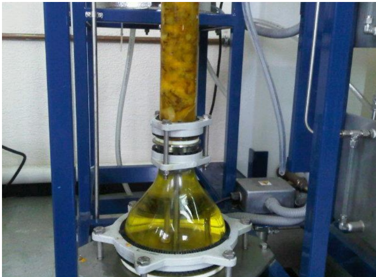
Figura 20 Foto del extracto obtenido con éter etílico en el equipo de extracción líquido-líquido UOP5 de ARMFIELD
