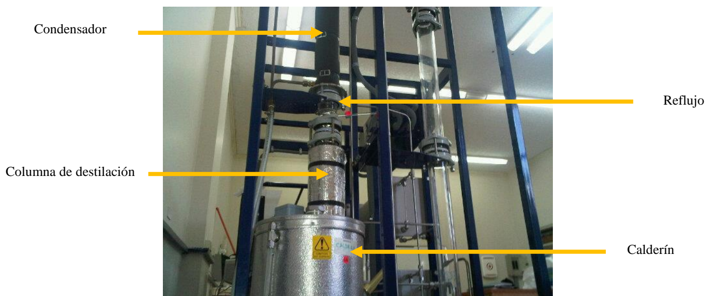
Figura 14 Columna de destilación del equipo de extracción líquido-líquido UOP5 ARMFIELD
