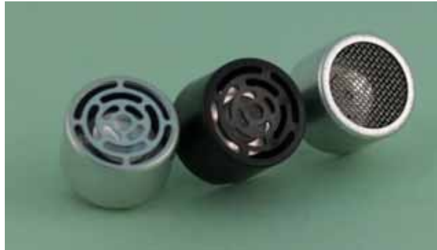
Figura 2: Transductores de ultrasonido del tipo sectorial. Fuente: Datasheet 3004 Transducer.
