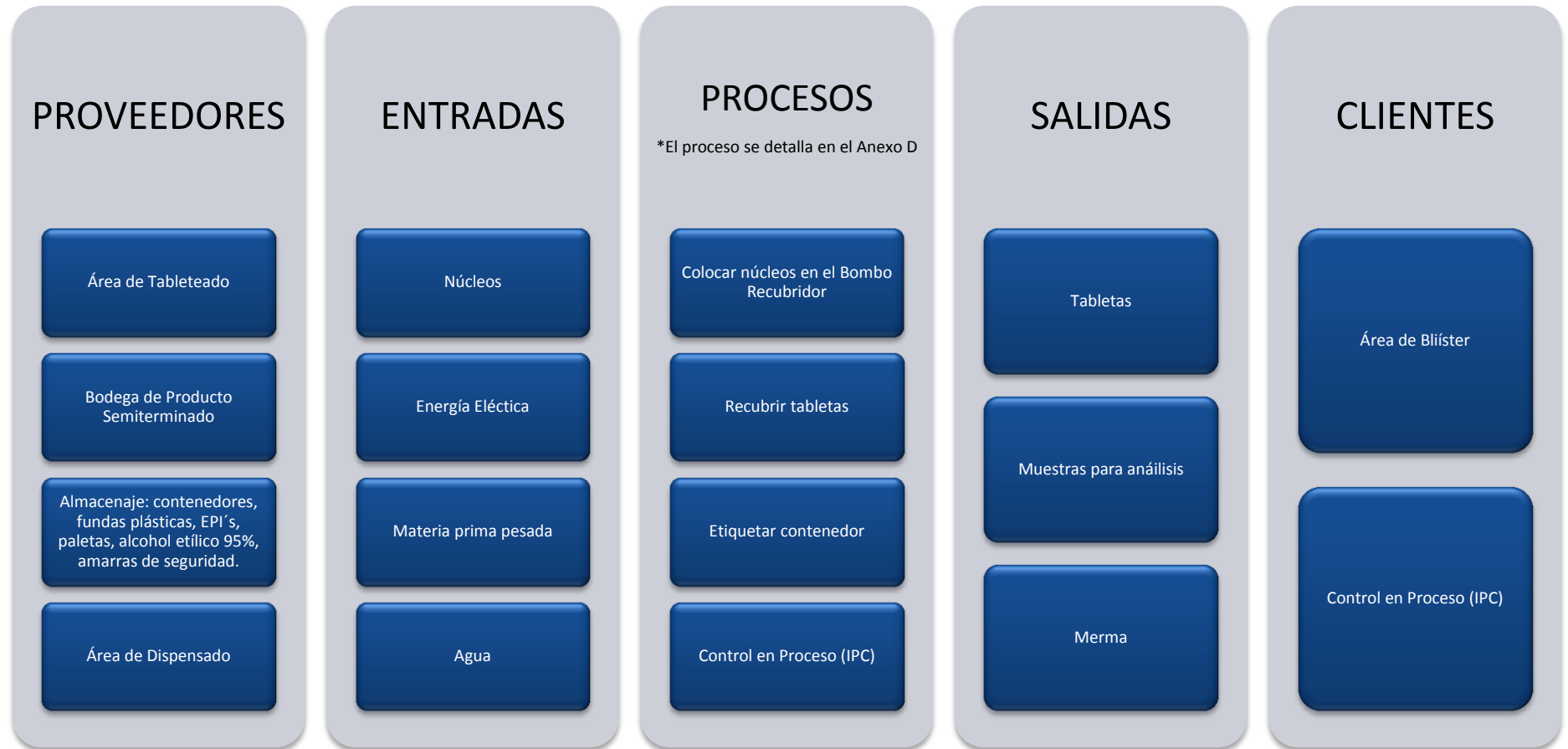
Figura 31. Diagrama SIPOC para el Proceso de Recubrimiento
