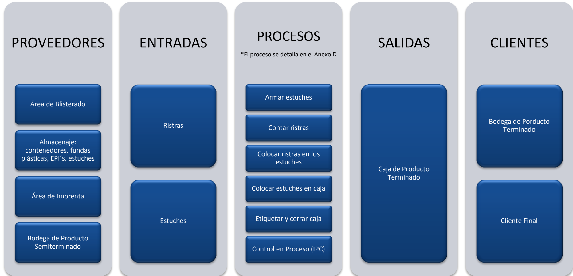
Figura 33. Diagrama SIPOC para el Proceso de Acondicionamiento
