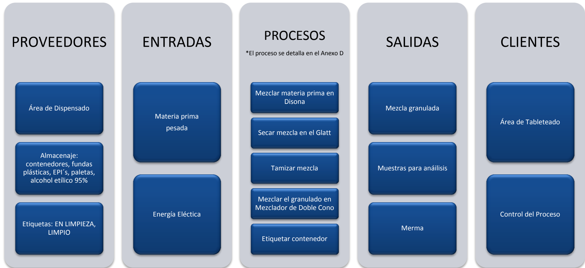
Figura 29. Diagrama SIPOC para el Proceso de Granulación
