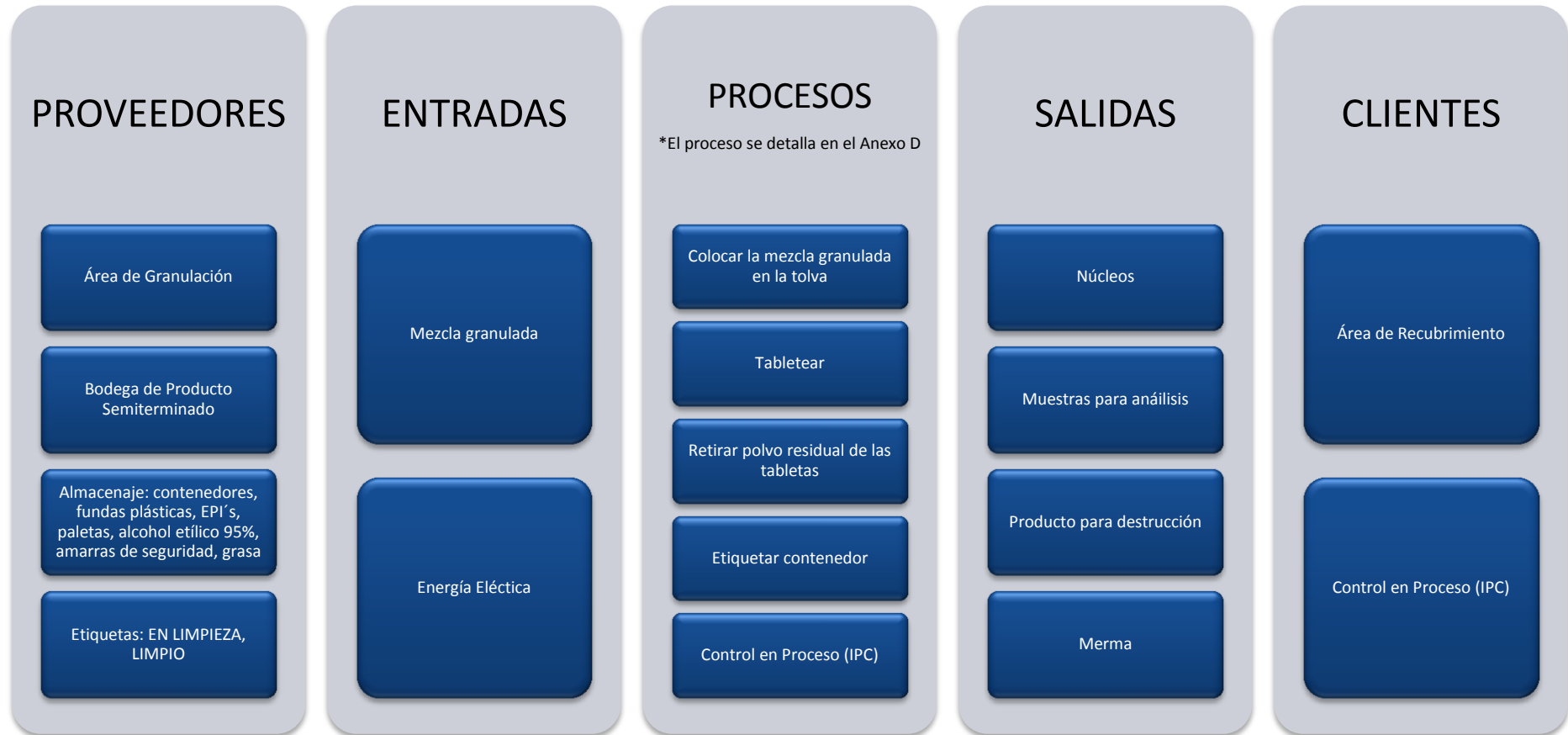
Figura 30. Diagrama SIPOC para el Proceso de Tableteado
