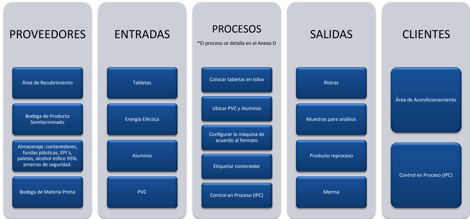
Figura 32. Diagrama SIPOC para el Proceso de Blíster
