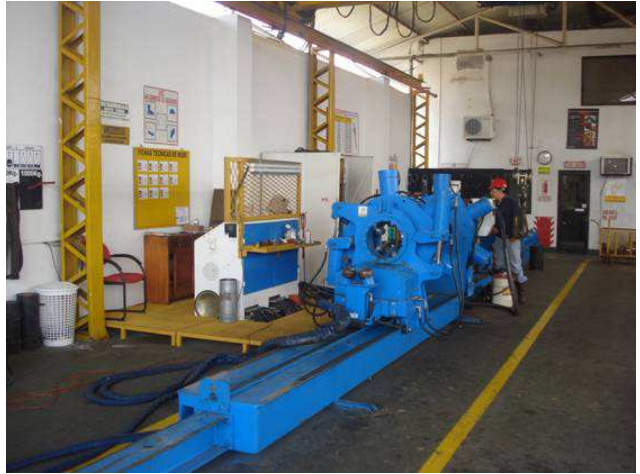
Torno usado para herramientas de completación de pozos.
