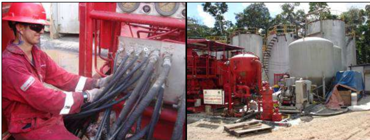
Fotografía No. 3. Izquierda. Personal de cementación preparando la unidad. Derecha: Unidad y tanques verticales en la locación Daimi B, en el bloque 16 de Repsol YPF en el RIG 121 de la empresa H&P
