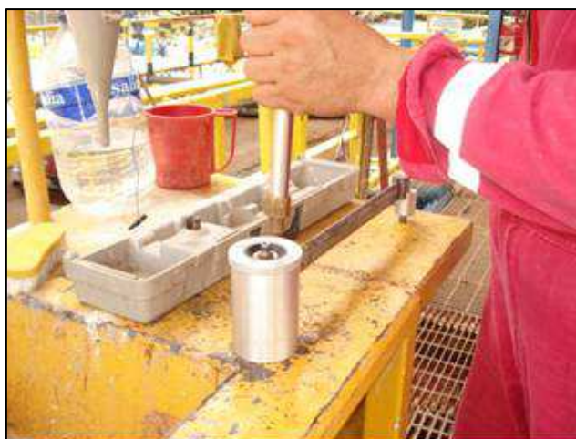
Fotografía No. 8. Personal de Halliburton realizando pruebas químico físicas junto a las tanques de lodo.
