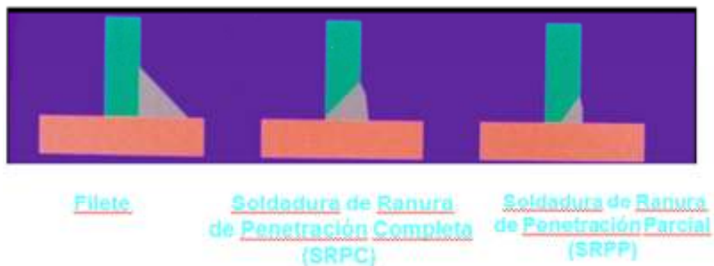
Figura 25. Gráficos de diferenciación entre diferentes tipos de soldadura (Rojas, 2012)
