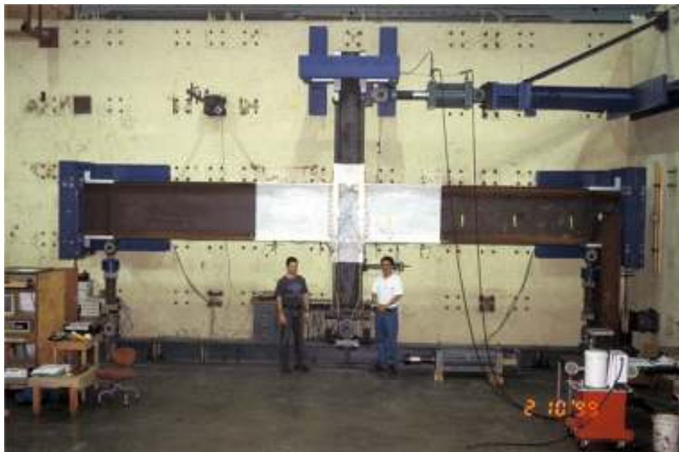
Figura 55. Configuración real de un ensayo bajo cargas cíclicas para la calificación de una conexión viga-columna interior (Engelhardt, 2007)
