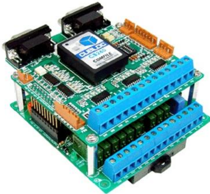
Figura 3. PLC marca CUBLOC [6]
