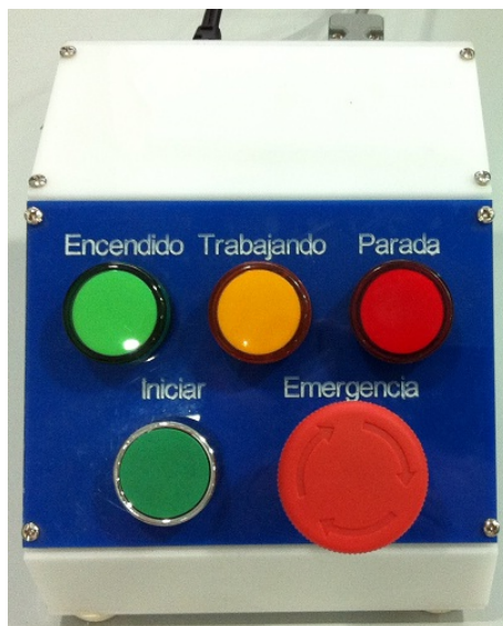
Figura 3.8. Producto final del panel de control
