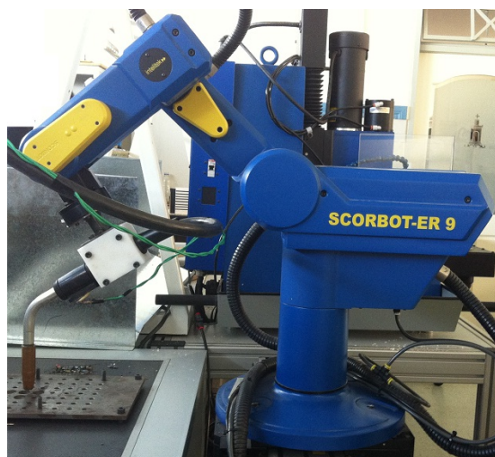
Figura 3.10. (continuación) Robot en posición de soldadura con la configuración calculada. c) Foto del robot en la configuración calculada previamente.
