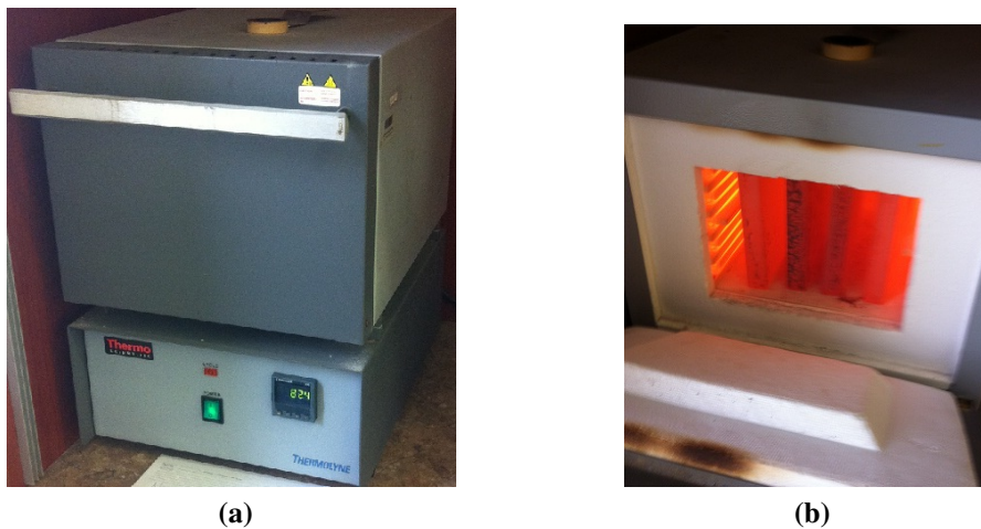
Figura 4.2. Tratamiento térmico de las probetas. a) Equipo utilizado. b) Probetas a temperatura de autenización.
