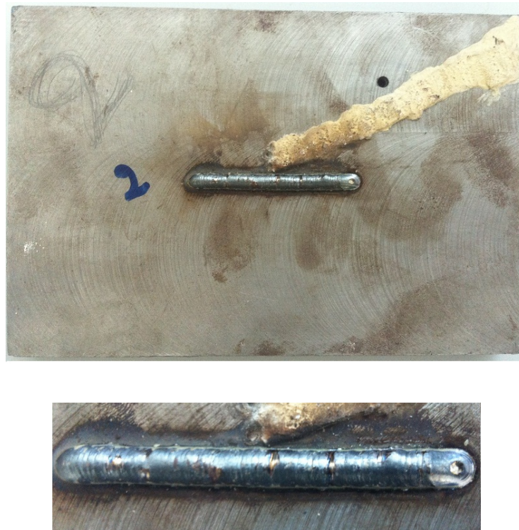
Figura 4.8. Placa de ensayo con el cordón de soldadura realizado
